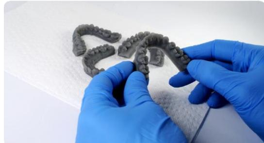
乾燥後もまだ湿った未重合のレジンが残っている場合は、スクイーズボトルを使用するか、パーツをきれいな IPA に約 1 分間浸してから、再度空気乾燥させます。この場合も、圧縮空気を使用すると迅速な乾燥が可能になります。
