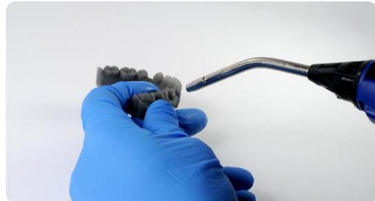
プリントされたパーツをチェックして、パーツが清潔で乾燥していることを確認します。次のステップに進む前に、表面にアルコール、余分な未重合レジン、残留粒子が残っていないことを確認してください。
