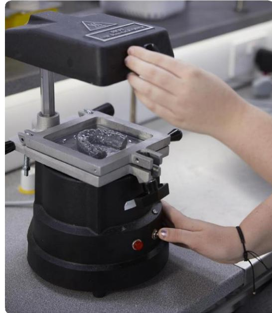
加圧式成形機は、正圧で材料をモデルの上に押し付けて成形します。
