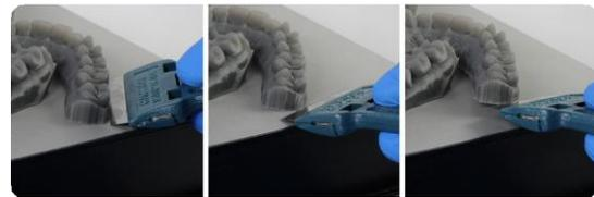
**ヒント:** 安全に使用すれば、カミソリの刃のようなスクレーピングツールはモデルをビルドプラットフォームから取り外すのに非常に効果的です。交換用ブレードは非常に鋭く、非常に手頃な価格です。鋭利なブレードはモデルとビルドプラットフォームの間に簡単に入り込むため必要な力が大幅に軽減されます。
