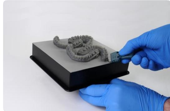
スクレーピングツールを使用して、モデルの周囲と下部を削ります。モデルの端の複数の部分に、軽くて一定の力をかけます。
